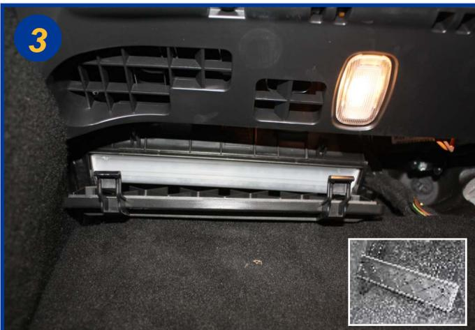
Retirer le couvercle en tirant dessus, celui-ci est guidé par 2 fourches (voir détail du couvercle dans l'encadré)
