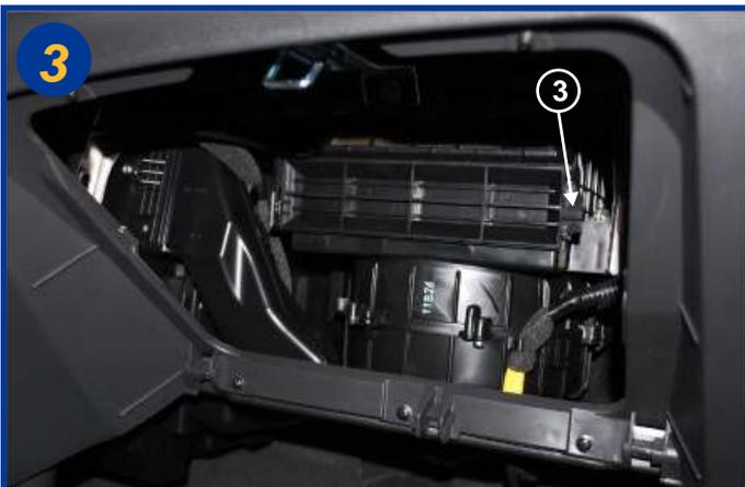
Ouvrir le boîtier filtrant du côté droit (3) en manipulant le loquet de fermeture. Le couvercle étant articulé sur le côté gauche. Extraire le couvercle.
