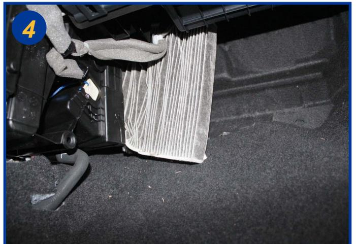
Extraire l'élément filtrant usagé en le déformant. Le nouvel élément sera compressé en accordéon pour l'insérer dans le boîtier. Le remontage s'effectue dans l'ordre inverse du démontage.
