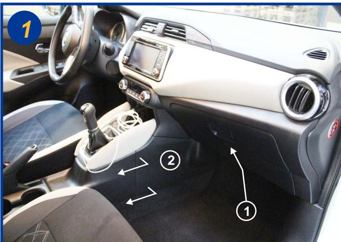
Le filtre d'habitacle est situé à l'intérieur du véhicule, côté passager sous la boîte à gants coté console (1). Dégrafer le carter plastique (2) puis le retirer dans le sens de la flèche.
