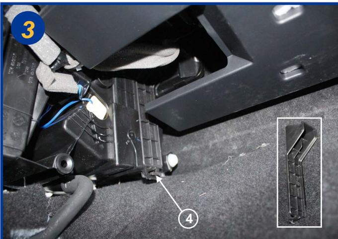
Ouvrir le boîtier en appuyant sur le loquet (4) et retirer le couvercle (détail du couvercle, voir encadré).
