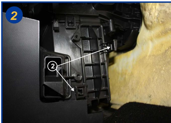
Ouvrir le boîtier filtrant à l'aide des 2 poignées (2) et retirer celui-ci.
