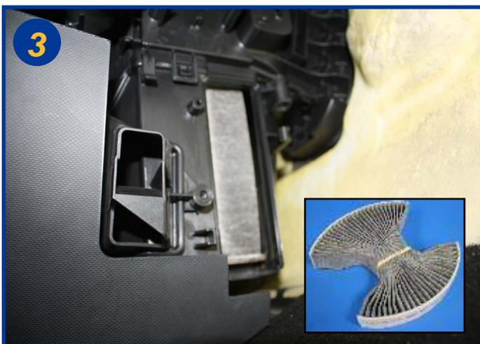
L'ouverture du climatiseur est 2 fois plus petite que la largeur du filtre donc il est nécessaire de le déformer pour le sortir de son logement. Pour remettre le nouveau filtre munissez-vous d'un élastique pour le comprimer (voir encadré)
