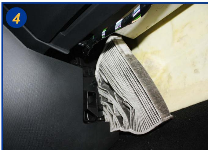
Insérer la moitié du filtre dans l'ouverture puis retirer l'élastique, le filtre peut alors être introduit correctement. Le remontage ensuite s'effectue dans l'ordre inverse du démontage.
