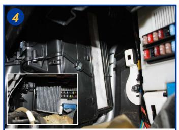
Extraire le filtre usagé en le déformant. Le remontage s'effectue dans le sens inverse du démontage.
