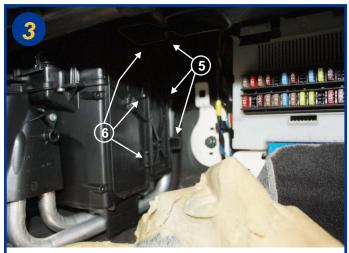
Ouvrir le boîtier filtrant en agissant sur les 3 pattes de fermeture (5) ôter ce couvercle qui est articulé sur le coté gauche (6).
