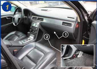
Le filtre d'habitacle est situé à l'intérieur du véhicule, coté passager sous la boîte à gants coté console (1). Exercer une pression sur le flanc de la console (2) pour le dégrafer et l'extraire totalement (voir encadré).
