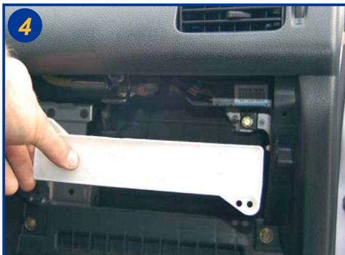
Sortir l'élément filtrant usagé et procéder à son remplacement. Le remontage s'effectue dans l'ordre inverse du démontage.
