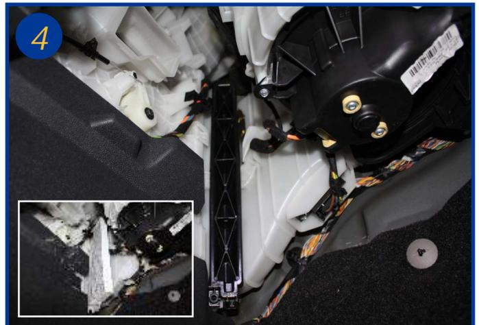
Ouvrir le boîtier filtrant en dégageant le couvercle (6) par le bas. Procéder au remplacement du filtre (voir encadré). Le remontage s'effectue dans l'ordre inverse du démontage.
