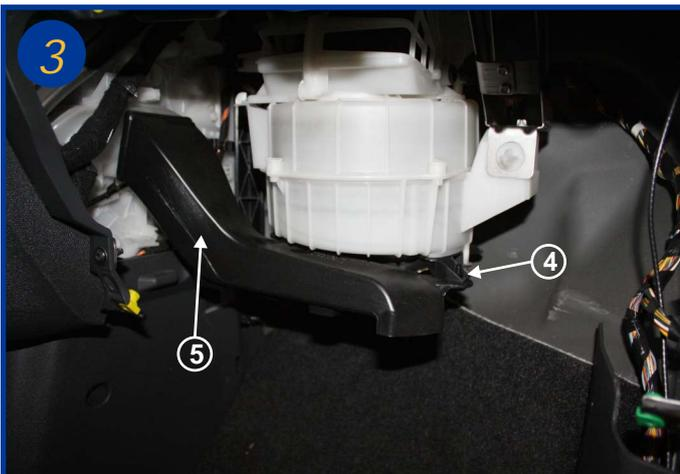
Retirer la goupille plastique (4) et dégager le conduit d'air (5).
