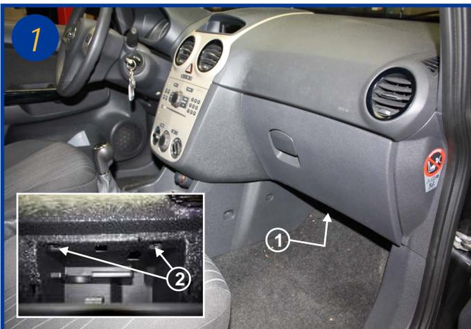
Le filtre d'habitacle est situé à l'intérieur du véhicule, côté passager derrière et sous la boîte à gants (1). Ouvrir la boîte à gants et dévisser les 2 vis Torx (T20)(2) (voir encadré). Refermer la boîte à gants.
