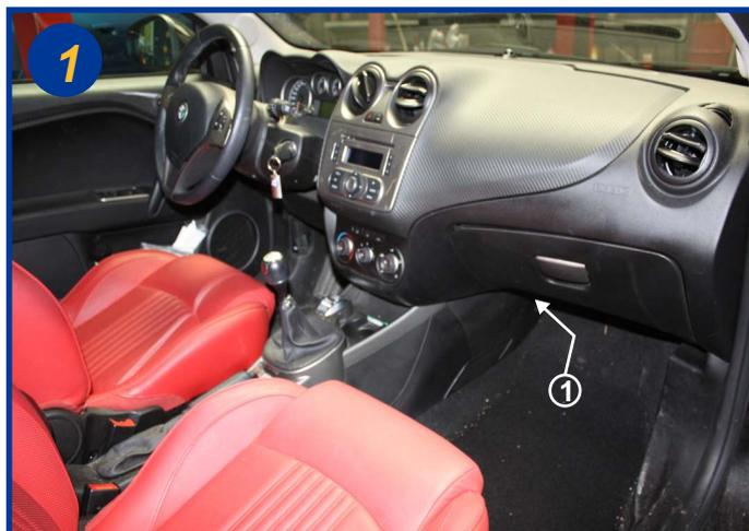
Le filtre d'habitacle est situé à l'intérieur du véhicule, côté passager derrière la boîte à gants coté console centrale (1).
