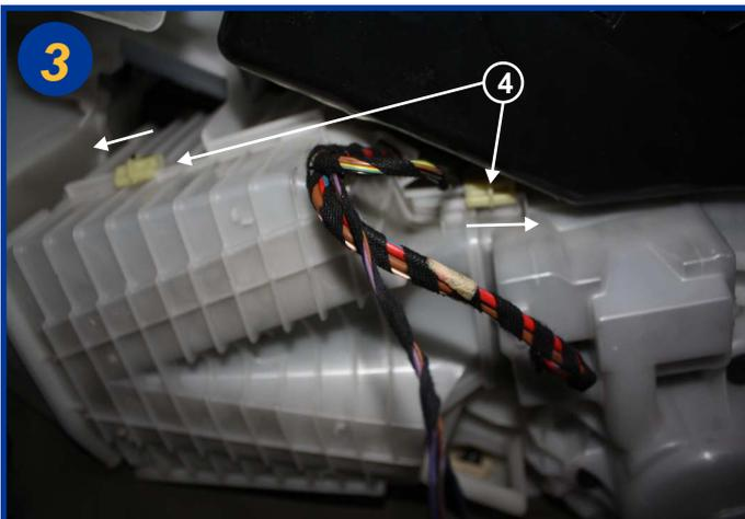
Faire coulisser les 2 pièces plastique (4) dans le sens des flèches et retirer le couvercle entièrement (sur sa partie arrière, il est juste emboîté).
