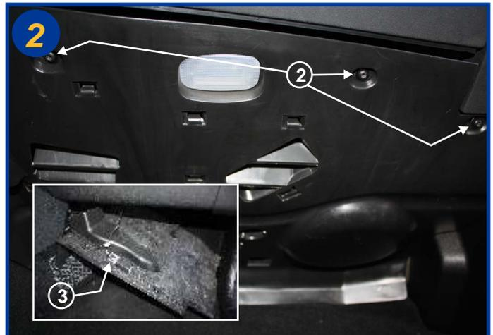
Dévisser sous la boîte à gants les 3 vis (2) Torx T20 et Retirer le carter plastique en prenant garde de dégrader la partie côté console centrale. Puis débrancher le plafonnier (3)(voir encadré). Retirer entièrement le carter.
