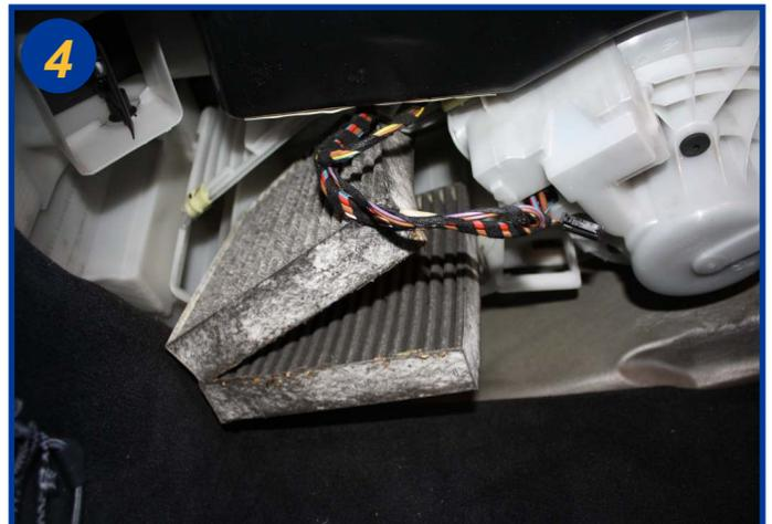
Extraire l'élément filtrant usagé, remplacer le nouvel élément (particularité: le filtre se plie en 2 sans se détacher). Le remontage s'effectue dans l'ordre inverse du démontage.
