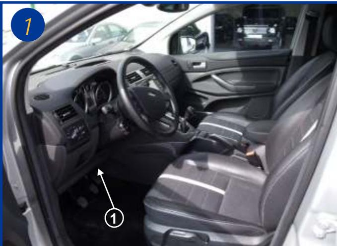
Le filtre d'habitacle est situé à l'intérieur du véhicule, coté conducteur à droite de la pédale d'accélérateur, coté console centrale (1).
