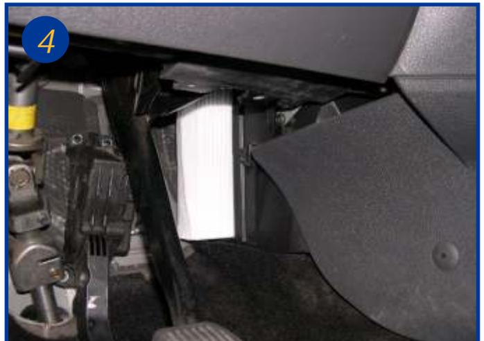
Ouvrir le boîtier filtrant et procéder au remplacement de l'élément filtrant.
