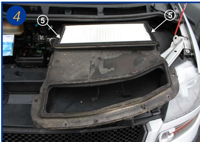
Extraire l'élément filtrant usagé, le remplacer en imbriquant les 2 premiers plis dans les nervures prévues (5). Le remontage s'effectue dans l'ordre inverse du démontage.
