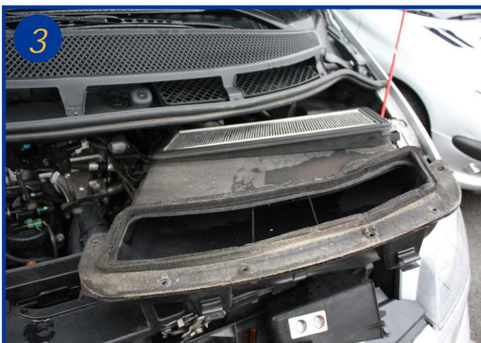
Dégager l'ensemble du boîtier filtrant, par la gauche dans un premier temps puis par la droite pour le sortir totalement.
