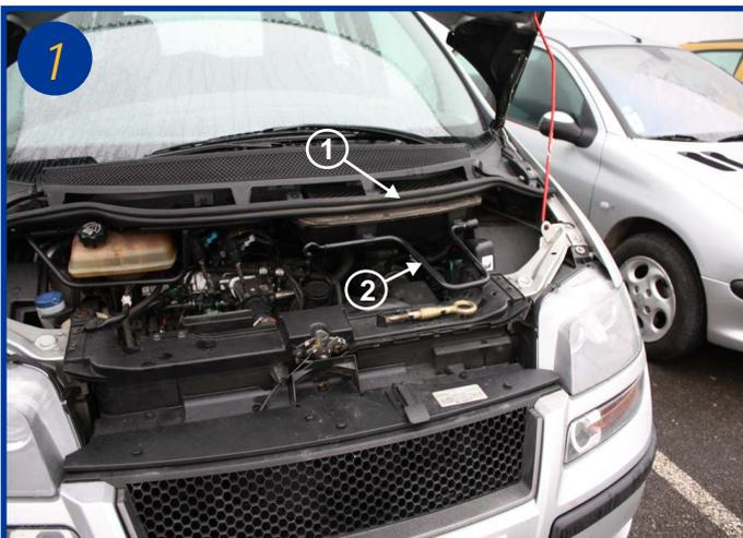
L'élément filtrant est situé sous le capot moteur coté conducteur (1)
