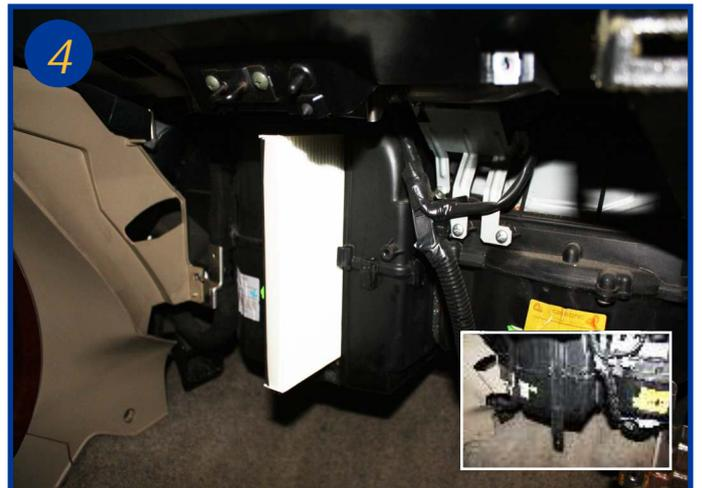
Ouvrir le boîtier filtrant en dévissant la vis cruciforme, puis faire coulisser le couvercle par le bas (voir encadré). Extraire le filtre usagé et le remplacer. Le remontage s'effectue dans l'ordre inverse du démontage.
