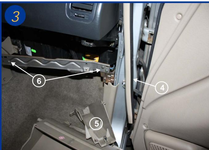
Sortir sur une petite partie le joint de tour de portière (4) et retirer la garniture plastique (5) fixée par 3 vis cruciformes. Dévisser ensuite les 3 vis cruciformes de maintien de la barre transversale (6).
