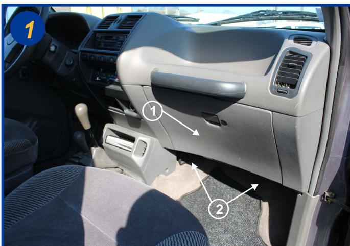
Le filtre d'habitacle est positionné à l'intérieur, coté passager derrière la boîte à gants (1).
