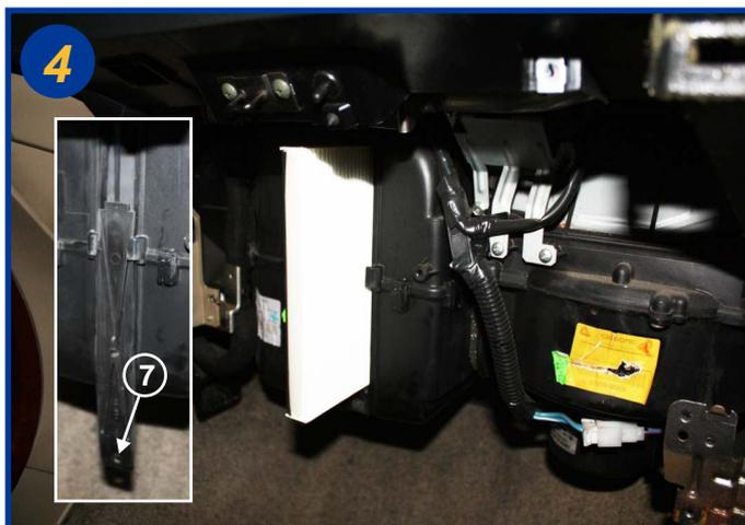
Ouvrir le boîtier filtrant en faisant coulisser le couvercle. (voir encadré) après avoir retiré la vis de fermeture (7).
