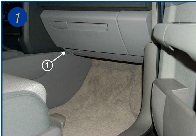
L'élément filtrant est situé sous la boîte à gants dans l'habitacle du véhicule coté passager (voir flèche 1). Ouvrir la portière avant droite.
