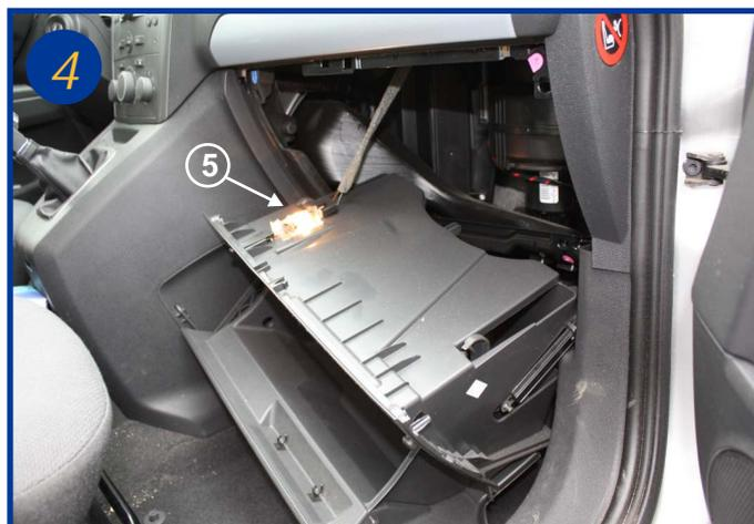
Extraire le bloc boîte à gants dans sa totalité en débranchant la lampe plafonnier de la boîte à gants (5).
