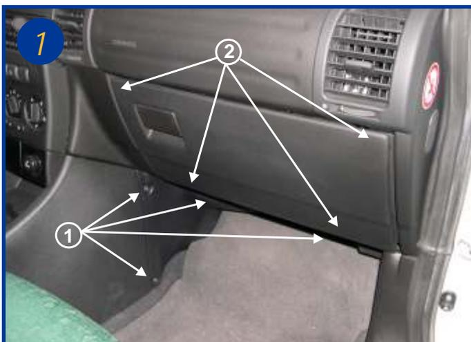
L'élément filtrant est situé derrière la boîte à gants.
