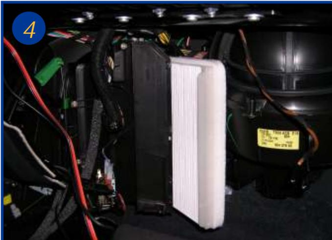
Extraire l'élément filtrant usagé, placer le nouvel élément filtrant dans ces rainures en évitant d'abîmer le joint en mousse autour de l'élément. Le remontage s'effectue alors dans l'ordre inverse du démontage
