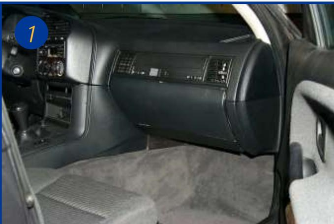
Le boîtier filtrant est situé derrière la boîte à gants, côté console centrale,
