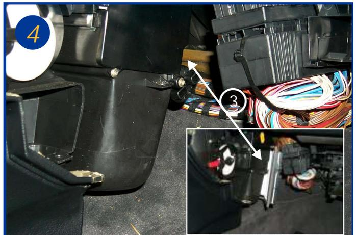
Le filtre d'habitacle est situé derrière le climatiseur, (voir repère 3). Remplacer alors le filtre usagé
