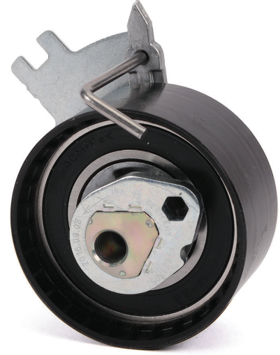
Resim 2: 531 0885 10 değiştirilmiş gergi rulmanı
