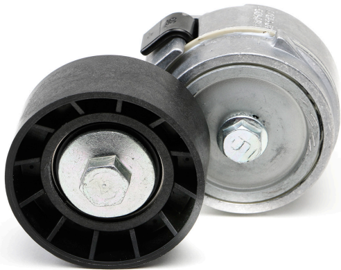
Εικόνα 1: Βραχίονας σύσφιξης 534 0101 20 – παλιός σχεδιασμός
