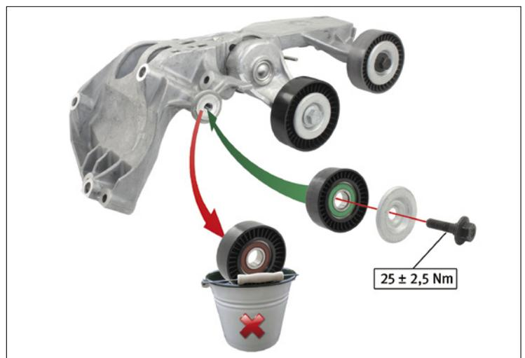
Bild 1: Spanneinheit 534 0243 10
