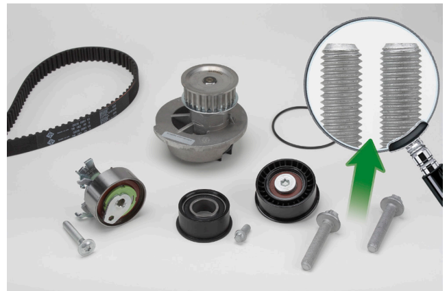
Зображення 1: Приклад комплекту для помпи INA 530 0443 30 з двома версіями гвинта шківів колінчастого вала
