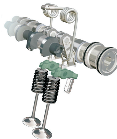
Imagem 1: Visão geral do BMW Valvetronic
