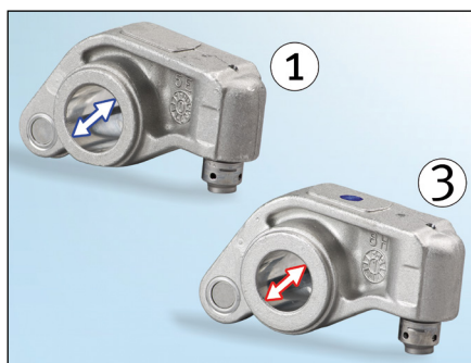
Slika 2: Poluga ventila usisa (1) je većeg presjeka
