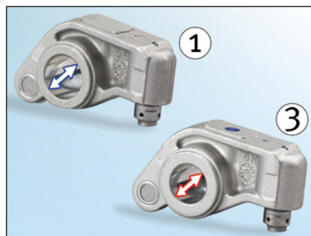
Fig. 2: El diámetro de la palanca basculante en la parte de entrada (1) es mayor
