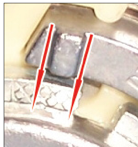
Slika 5: Obe zarezi sta zunaj utora (puščici) Nastavitev je treba popraviti!
