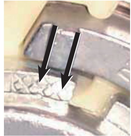
図 6 両方のノッチが切り欠きの外側にある状態（矢印） 設定を正しく調整する必要があります！
