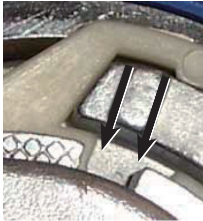
図 5 両方のノッチが切り欠きの内側にある状態（矢印） この設定が適正です！
