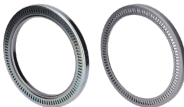
Fig. 1: O anel original para o ABS (lado esquerdo) já não deve ser utilizado. Em vez deste, deve ser utilizado o anel ABS (lado direito) fornecido com a RIU.
