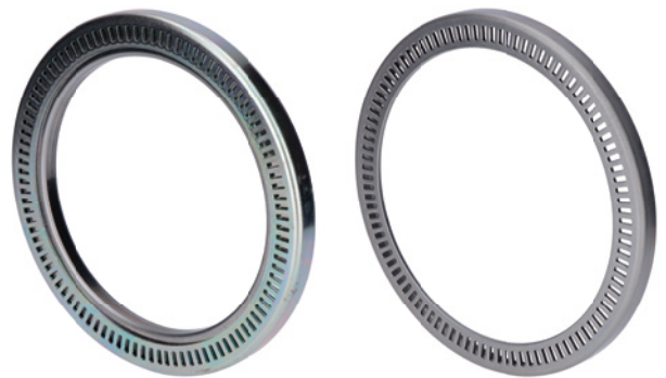
Image 1: Le joint avec bague ABS d'origine (gauche) ne doit plus être utilisé. Au lieu de cela, la bague ABS fournie avec l'unité de roulement Repair Insert Unit (RIU) doit être montée.
