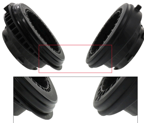
Obrázek 1: Opěrné uložení pružinové jednotky s ochranou proti stříkající vodě (vlevo) a bez této ochrany (vpravo)
