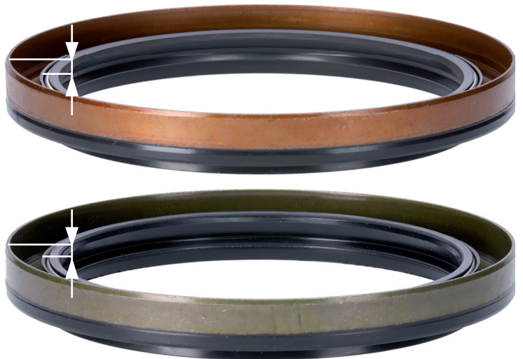
Afbeelding 2: De afdichtingslip van de meegeleverde as-afdichtingsring (boven) verschilt slechts weinig ten opzichte van de oorspronkelijk ingebouwde uitvoering (onder)
