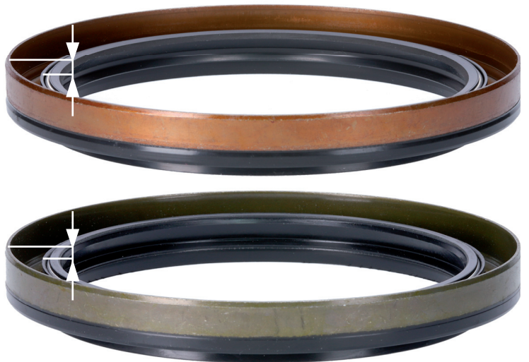
Photo 2: La lèvres d'étanchéité de la bague d'étanchéité fournie (en haut) ne diffère que légèrement de la version originale installée (en bas).
