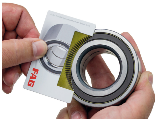
Bild 1: Genom indikeringskort kan monteringsidan hos en multipol-enkoder fastställas. Hos passiva enkodrar fungerar inte detta
