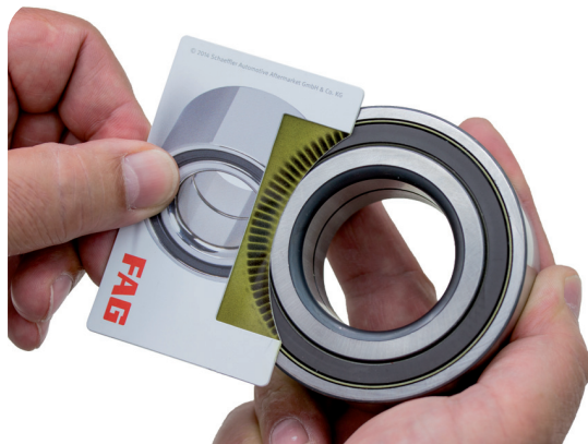
Figura 1: La scheda encoder consente di stabilire il lato di montaggio dell'encoder multiplo. Per gli encoder passivi ciò non funziona
