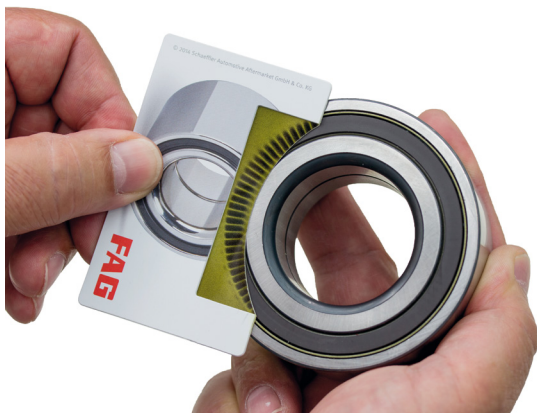
Kuva 1: Enkooderikortin avulla voidaan määrittää moninapaisen enkooderin asennuspuoli. Passiivisissa enkoodereissa se ei ole mahdollista
