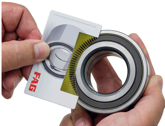
Εικόνα 1: Η κάρτα κωδικοποιητή μπορεί να χρησιμοποιηθεί για τον καθορισμό της πλευράς τοποθέτησης ενός πολυπολικού κωδικοποιητή. Αυτό δεν είναι εφικτό με παθητικούς κωδικοποιητές.
