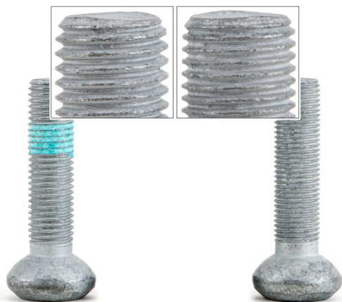
Bild 1: Vänster skruv: M12x1,5 Höger skruv: M12x1,25
