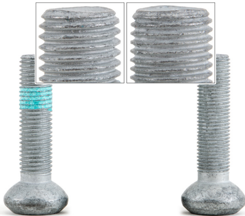
Kuva 1: Vasen ruuvi: M12x1,5 Oikea ruuvi: M12x1,25
