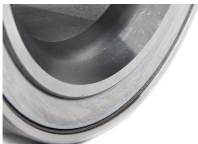
Bild 3: Truck Hub Unit (lagerenhet till hjulnav) med avkortad kant
