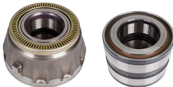
1. ábra: TAM (trans axle modul) és THU (truck hub unit)
