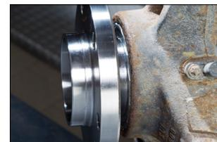
Рис. 3: Убедитесь, что стопорное кольцо встало на посадочное место и располагается заподлицо с поворотным кулаком
