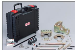
Рис. 2: Специальный инструмент 400 619910 обязателен при монтаже подшипника
