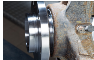
Figur 3: Låseringen skal ligge i flukt med styrespindelen
