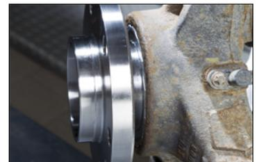
Photo 3 : La bague de sécurité ne doit pas ressortir par rapport à la fusée
