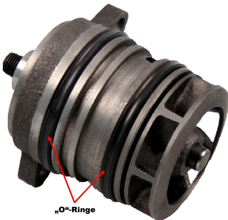
Beim Einbau dürfen die Dichtringe nur mit Kühlmittel benetzt werden!
