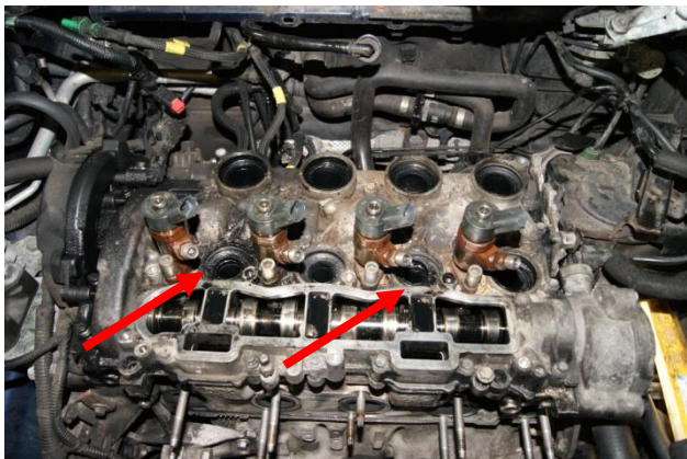
Imaginea 1: răspândirea gazului în galeria de admisie – reetanșezați-o
