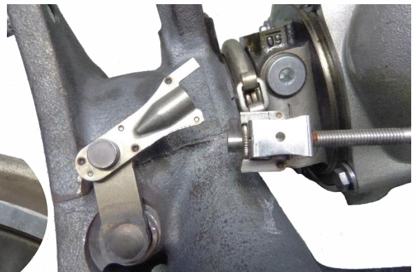
Bruch der Regelstange
