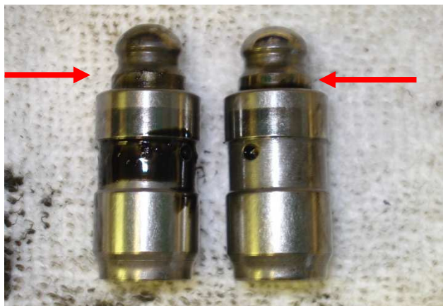
Obrázek 3: Hydraulické zdvihátko ventilů vlevo úplně vyjeté, ventily netěsné + zdvihátko vyměnit
