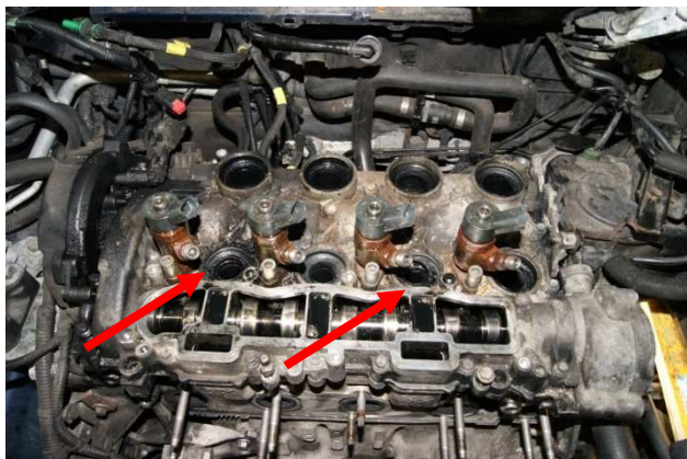
Obrázek 1: Místa přechodu plynu na koleně sacího potrubí – nově utěsnit
