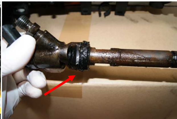
Obrázek 2: Zavěšení u držáku trysky netěsné – nově utěsnit
