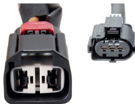
Fig. 3 : Forme des nouveaux connecteurs
