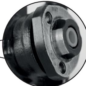
**BG** **Внимание:** Преди монтажа проверете плътното прилягане на шайбата на ремъка върху адаптерния фланец и при необходимост отстраниете излишната антикорозионна защита (вижте фиг.). Поставете болтовете с осигурявката на болтовете и ги затегнете с предписания от производителя на автомобила вътрещ момент.
