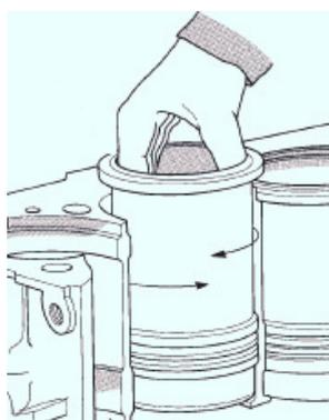
3. Con la ayuda de un reloj comparador, **mida la altura** entre el saliente de la camisa y el bloque, en los 2 puntos indicados. Siempre del lado del árbol de levas.
