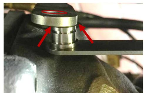
Bild 3: Der Hebelweg ist zu kurz. Eine
